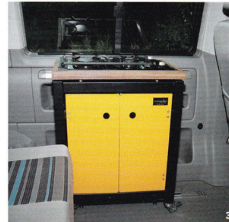
3 | Die neueste Entwicklung ist der KW60 mit 59 cm Breite, hier eingebaut in einem VW-Bus T5.
